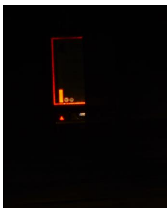
Obr. 18: Viditelnost návěsu na vzdálenost 100 m, potkávací světla
