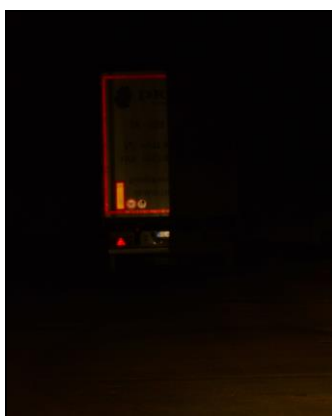
Obr. 19: Viditelnost návěsu na 40 m, potkávací světla
